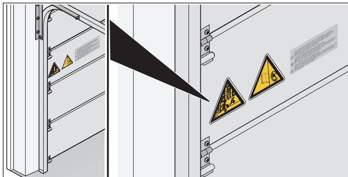
III. 1.2 Pose des autocollants sur le tablier
