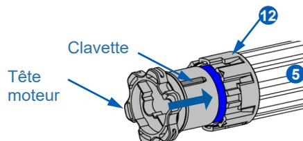
Pour tous les moteurs, enfoncer délicatement le moteur dans l'axe (5) jusqu'en butée contre l'épaulement de la couronne moteur.
