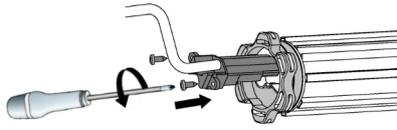
Engager en poussant la tête du moteur dans le support (8) et, pour moteur SOMFY uniquement, remettre en place l'anneau (9). Vérifier le bon maintien du moteur.
