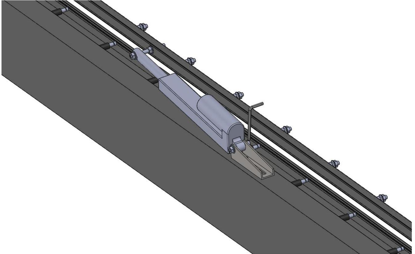
Ensuite il faut desserrer les bagues d'arrêt puis commencer à monter chaque lame dans le goujon de la poutre basse et pousser vers le goujon de la poutre haute jusqu'à ce que la pièce d'entraînement touche l'entretoise (en noir) et resserrer la bague d'arrêt (sans insister sur le serrage), et pour simplifier la fixation des lames il faut commencer par la première et la dernière lame; comme illustre les figures ci-après :
