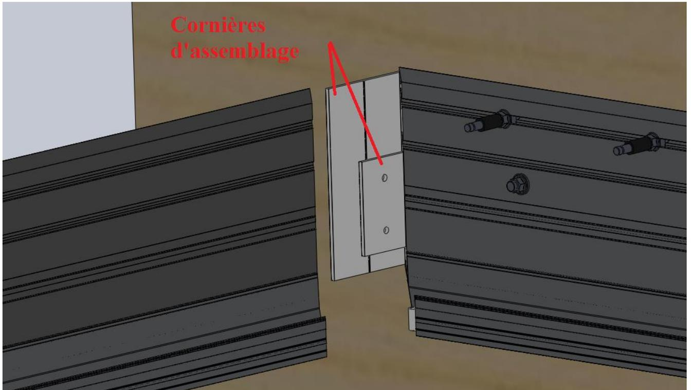
Puis remettre les vis d'assemblage et biens serrés.
