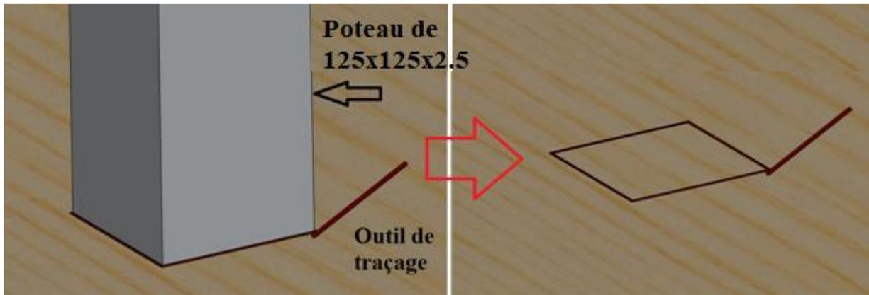
Puis enlever le poteau et fixer la platine de sol en utilisant des tiges filetées de **D10mm** et d'**au moins 100 mm de longueur** :
