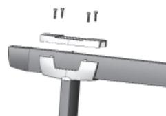
Placer la fixation articulée sur le chapeau renforcé, sans serrer les vis à fond, pour pouvoir aligner les profils de guidage
