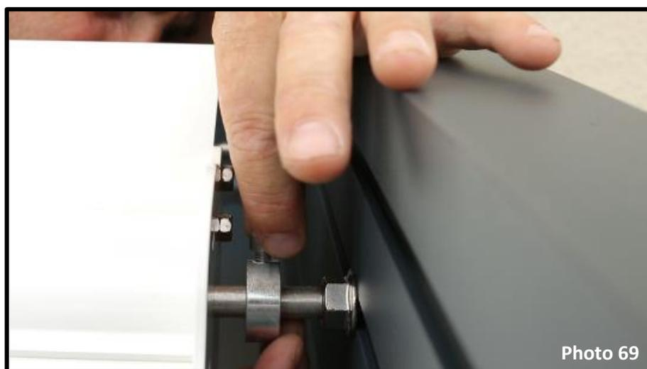
Poussez la lame et placez l'arrêt contre la lame pour qu'elle ne coulisse plus sur l'axe (photo 69).
