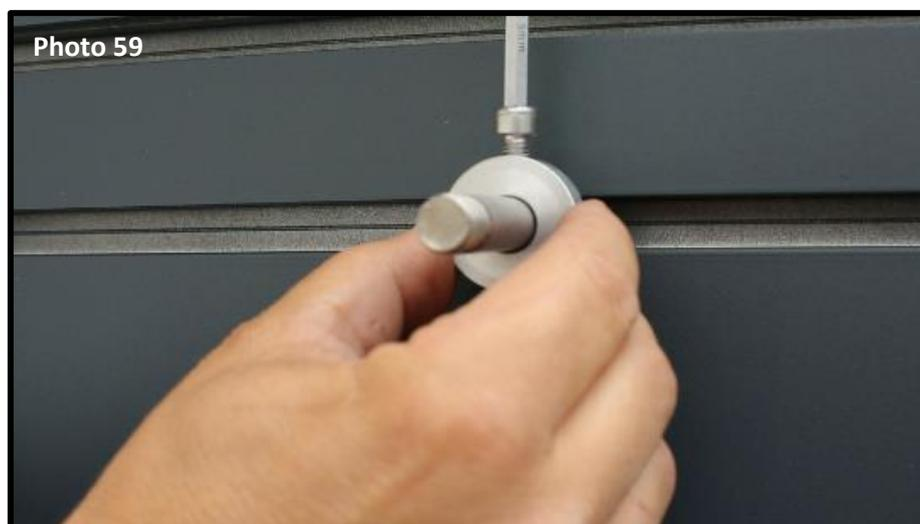
Du côté opposé, sur l'autre poutre transversale, dévissez un peu le bloqueur (photo 59).
