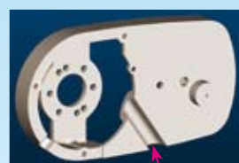
Passage manœuvre de secours du moteur
