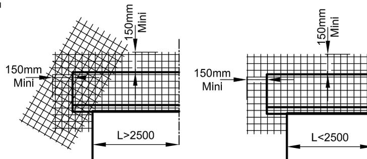
Pose de l'armature de l'enduit extérieur selon DTU 26.1
