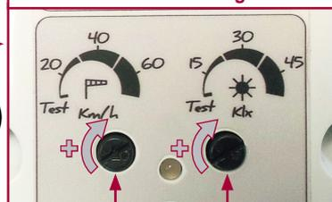
**Réglage capteur vent**
