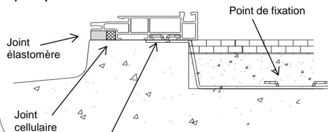
**Astuce:** Avant de mettre en place le seuil PMR, faire un cordon de joint élastomère sur l'appui maçonnerie
