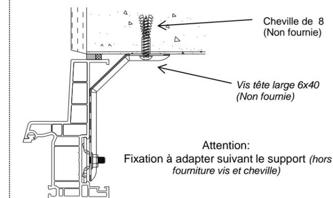
Attention: Fixation à adapter suivant le support (hors fourniture vis et cheville)
