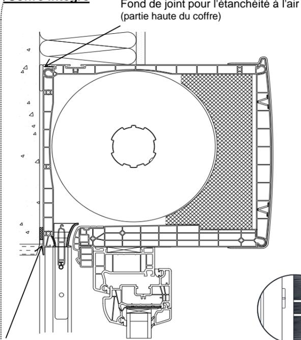
**Joint mastic extrudé pompe, pour la solidarisation de la face du coffre par rapport au linteau.**
