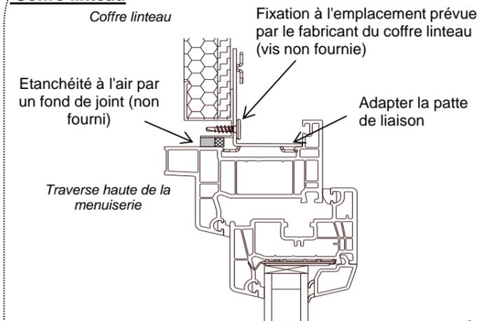
**La position de la traverse est différente suivant l'épaisseur du doublage (Ex: Doublage de 120).**
