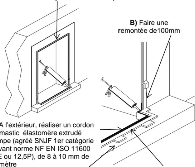
D) A l'extérieur, réaliser un cordon de mastic élastomère extrudé pompe (agréé SNJF 1er catégorie suivant norme NF EN ISO 11600 25E ou 12,5P), de 8 à 10 mm de diamètre
