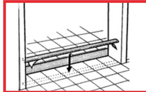
**06** Aligner les plaques de fixation au rail supérieur et inférieur des deux cotés. Une fois aligné fixer les plaques de fixation des deux cotés.
