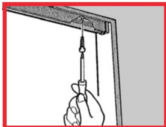
**05** Installer le rail inférieur aligné sur le supérieur. Enlever le papier de la bande adhésive et appuyer.
