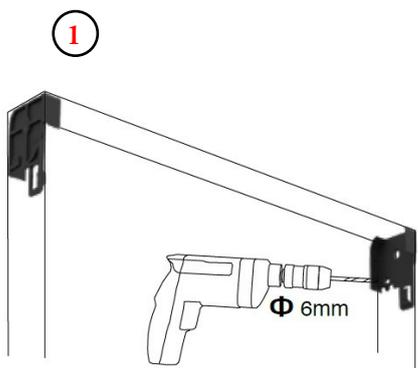
Positionner vos joues de support de caisson. Une fois positionner, percer avec un foret de 6mm et les fixer avec les vis fournies.
