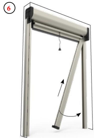
Insérer les guides télescopiques avec le pied de coulisse dans les guides compensateurs.
