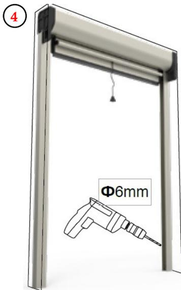
Positionner les guides compensateurs. Percer le mur avec un foret de 6mm et visser les guides .
