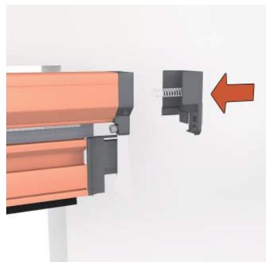
Monter les ressorts dans les joues gauche et droite et positionner les sur le caisson.
