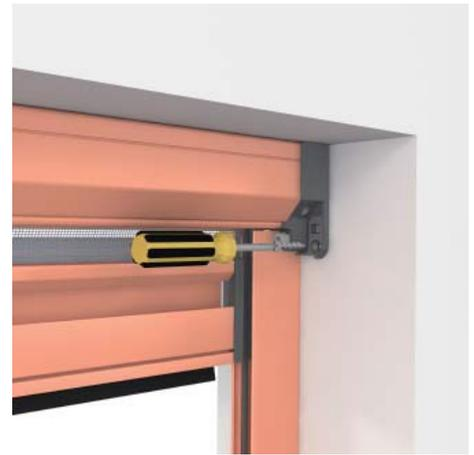
Vérifier immédiatement par des essais si le caisson nécessite une vis de blocage supplémentaire.
