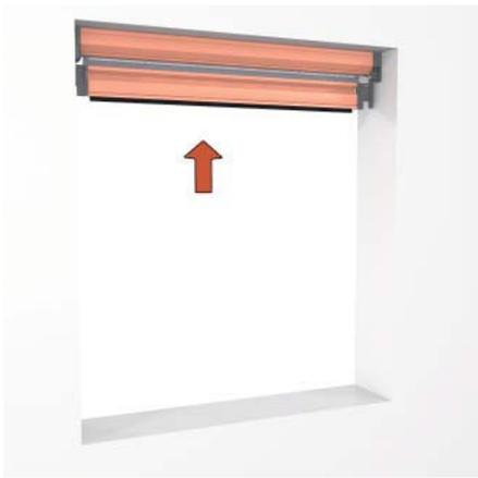
Placer le caisson en appui dans le tableau prêt à être fixé.
