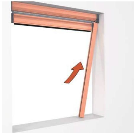
Percer les coulisses en un ou deux points. Insérer les coulisses gauche et droite sous les joues comme sur le schéma ci-dessus.
