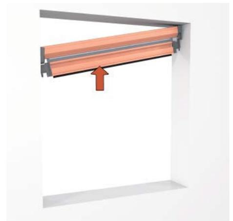
Compresser les deux joues et mettre en place le caisson comme sur le schéma ci-dessus.
