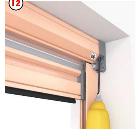
Pour ajuster la puissance du ressort, utiliser la clé fournie. Utiliser une vitesse réduite sur la visseuse.
