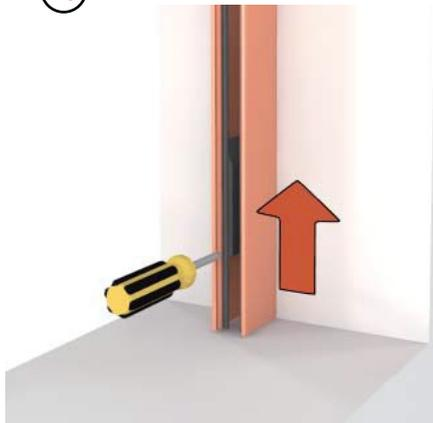
Pour version « Move up » ajuster le blocage pour une ouverture et fermeture optimale.
