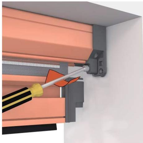
Une fois le caisson positionné, serrer les vis gauche et droite avec une force raisonnable pour bloquer le caisson.
