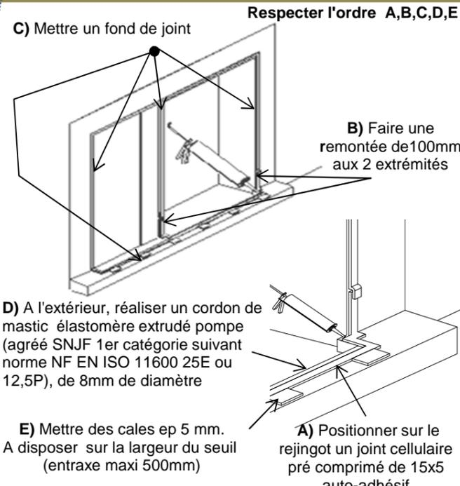
**Nota:** Si produit avec caisson d'isolation, insister fortement sur le point " D " et particulièrement sur le mastic colle au niveau des montants tableaux.
