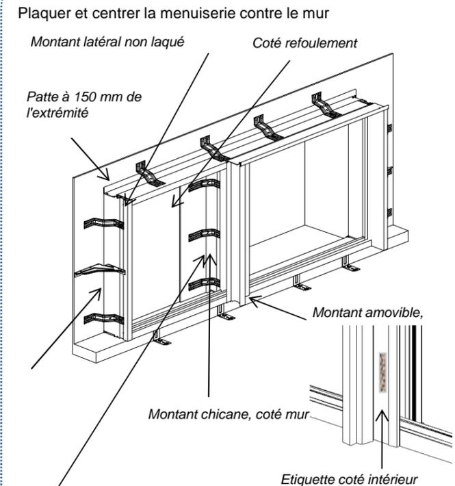
**Nota:** Si produit avec caisson d'isolation ne pas mettre de fixation au niveau du montant chicane, uniquement mastic colle impératif.
