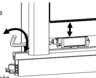
Mise en place et réglage poignée (si prévue dans l'offre produit)
